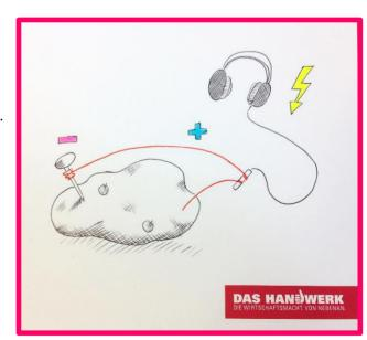
Der Strom fließt, weil beide Ladungen nun miteinander verbunden werden. Durch den Kopfhörer wird der Stromkreislauf geschlossen und man kann ein Knacken hören.
